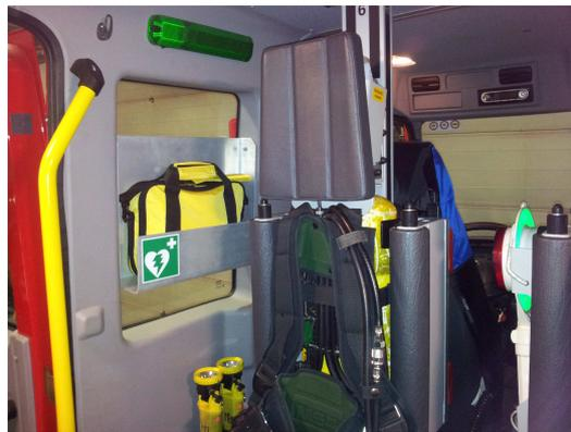
Im Zuge des Einbaues der Halterung wurde die Winkerkelle auf der mittleren PA-Halterung linksseitig angebracht (analog der auf der rechten Seite bereits vorhandenen).
